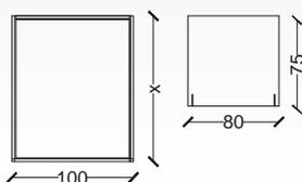
Realizziamo pannelli divisori in plexiglass o policarbonato con struttura portante in tubo quadro di alluminio anodizzato sezione cm 2,5.
